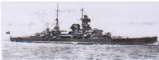
Die ADMIRAL HIPPER, Schiffstyp „Schwerer Kreuzer“ Länge 202 M, 132000PS, 1500 Mann Besatzung
